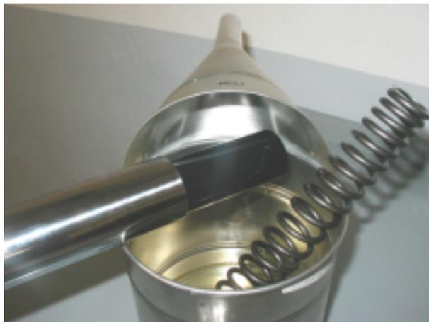
**IMPORTANTE** Per facilitare la fuoriuscita dell'olio contenuto all'interno dell'asta pompante effettuare dei pompaggi spingendo lo stelo all'interno del fodero portaruota.
